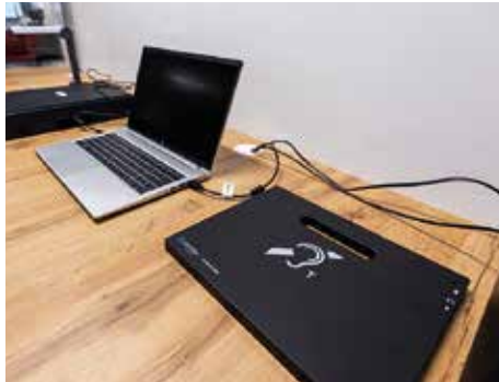
Pętla indukcyjna zamienia dźwięk na fale elektromagnetyczne docierające do aparatu słuchowego
